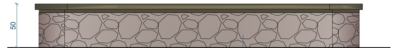
Remontuojamos esamų suolų akmenų mūro atramos
